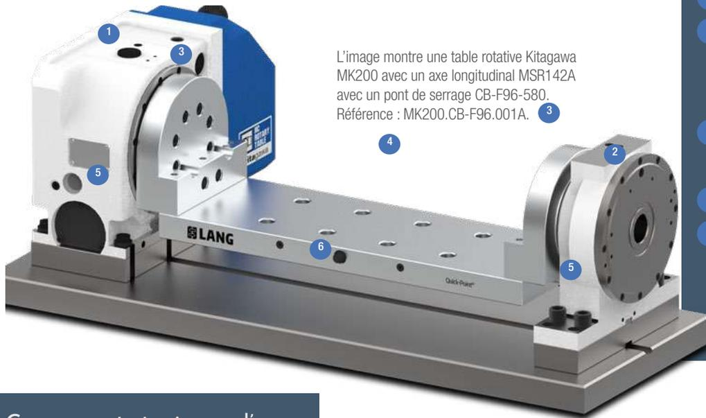
L'image montre une table rotative Kitagawa MK200 avec un axe longitudinal MSR142A avec un pont de serrage CB-F96-580. Référence : MK200.CB-F96.001A.
